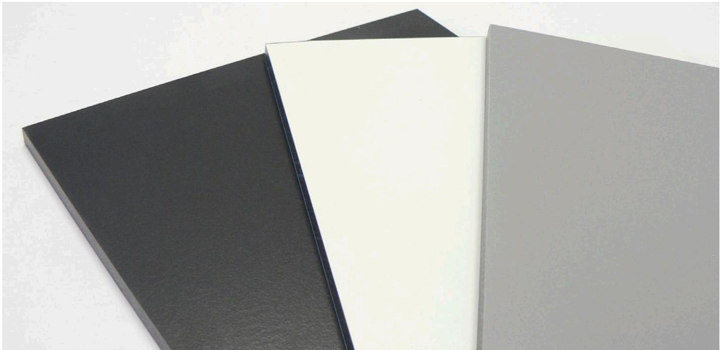
UNIPLAN – die preiswerten duroplastischen Hochdrucklamine (HPL = High Pressure Laminates), sind für den Innen- sowie den geschützten Außenbereich geeignet. Sie weisen eine leicht zu reinigende, harte Oberfläche auf. UNIPLAN Baukompaktplatten lassen sich einfach mit hartmetallbestückten Werkzeugen zur Holzbearbeitung sägen, bohren und fräsen.
