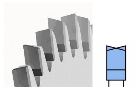
Abbildung 9: Wechselzahn (Quelle: Leitz GmbH & Co. KG)
