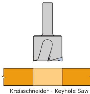
Abbildung 17: Kreisschneider (Quelle: Leitz GmbH & Co. KG)
