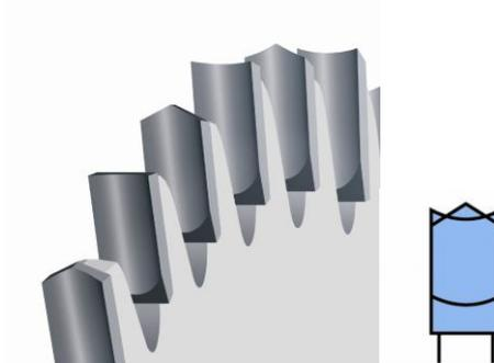
Abbildung 11: Dachzahn / Hohlzahn (Quelle: Leitz GmbH & Co. KG)
