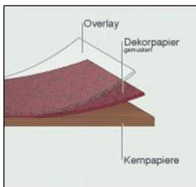
Abbildung 1: Schichtstoffplatte
