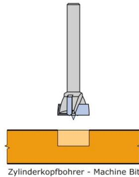
Abbildung 16: Zylinderkopfbohrer (Quelle: Leitz GmbH & Co. KG)
