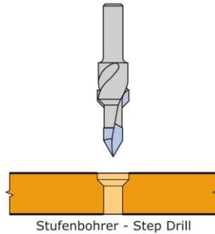
Abbildung 15: Absatz- / Stufenbohrer (Quelle: Leitz GmbH & Co. KG)
