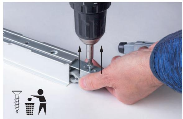
Lösen und entfernen Sie die alte Schraube.
